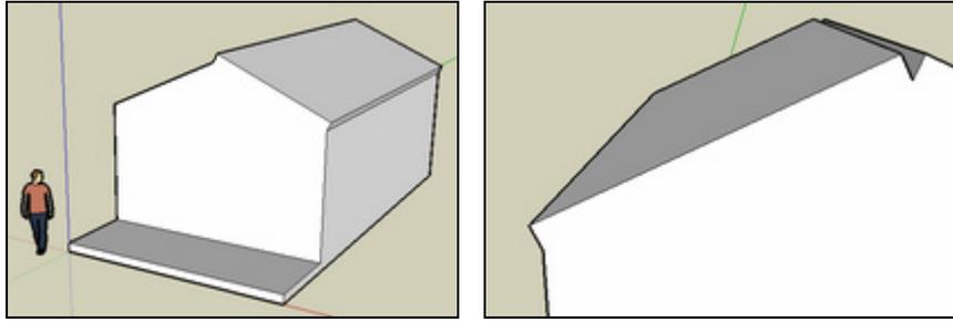
6. Tracer 2 lignes pour donner une épaisseur. Extruder le bord du toit pour créer un avant-toit. Attention : les 2 avant-toits doivent arriver au même niveau
