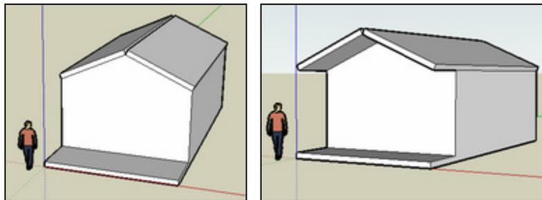
7. Tracer un arc de cercle pour relier les 2 pentes de toit. Faire pivoter le dessin et extruder cette forme en la tirant vers l'autre extrémité du toit
