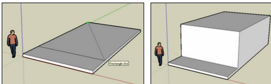
4. Tracer une ligne sur le milieu (l'infobulle « Point du milieu » vous aide à centrer la ligne) et créer le toit (ligne bleue pour obtenir la verticale) - Hauteur du toit : 1 m
