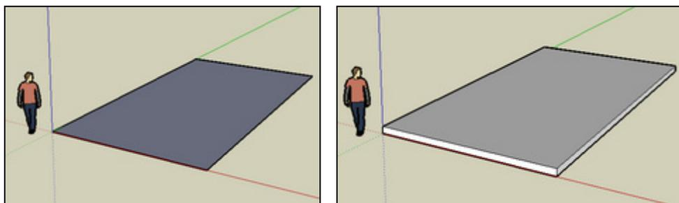
3. Tracer un contour intérieur (rectangle d'or) et extruder le vers le haut (2 m). Le carré aura un côté de 4 m
